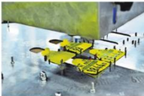
▲ Laseren van een nummer op een oormerk bij Plastifran.
